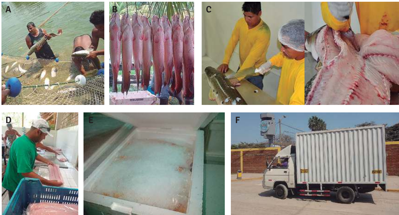
Figura 22. Proceso de post-cosecha de paiche en una empresa dedicada al engorde de esta especie en Loreto (Peces & Pescados SAC). A) Selección. B) Desangrado, C) Retiro de piel, eviscerado y fileteado. D) Embolsado. E) Refrigerado. Fotos. Jorge Ayarza (IIAP).
