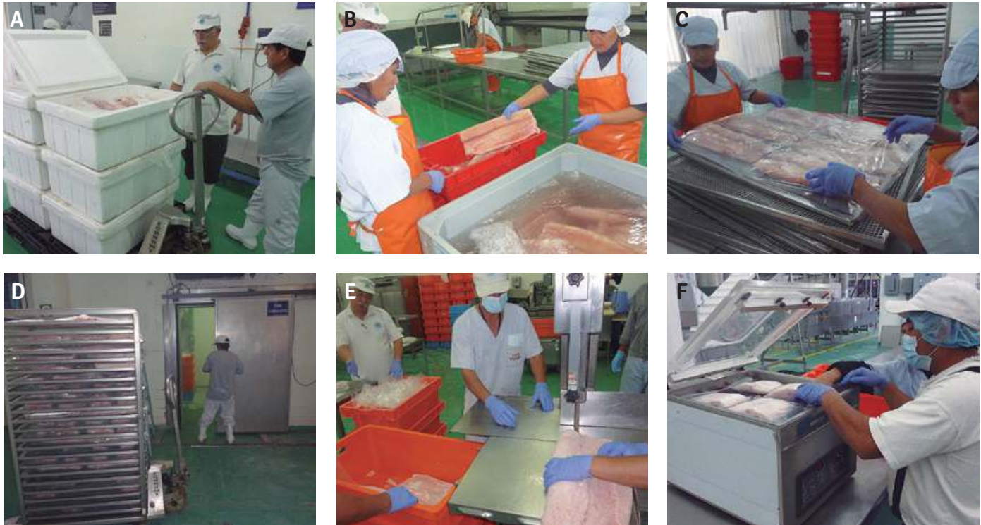
Figura 23. Procesamiento de filetes en planta. A) Desembarque en planta. B) Uniformización de temperatura en hielo y agua. C) Emparrillado para congelamiento. D) Congelamiento en cámara. E) Corte de filete. F) Empacado y sellado al vacío. Imágenes tomadas en el Instituto Tecnológico de la Producción (ITP Sede Ventanilla). Fotos. Jorge Ayarza (IIAP).
