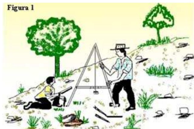
El nivel A y su utilización: las estacas pueden colocarse cada cinco medidas (cada 10m) o más frecuentes si el trazado curva o zigzaguea mucho.
